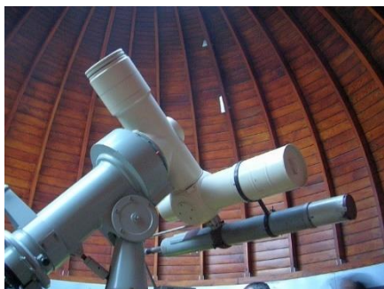
Hlavní dalekohled hvězdárny – Coude refraktor 150/2250 s připojeným refraktorem 130/1600.
