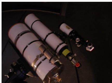
Hlavní dalekohled je Maksutov-Cassegrain s průměrem 202 mm a 110 mm achromat.
