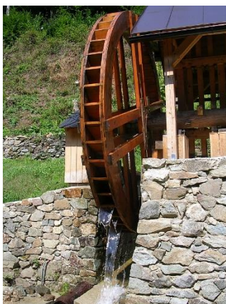
Dobový drtič kamení. Pro názornost nám byl i spuštěn, z čehož plyne, že proti proudu musí být zřejmě nějaký, alespoň malý tajch.
