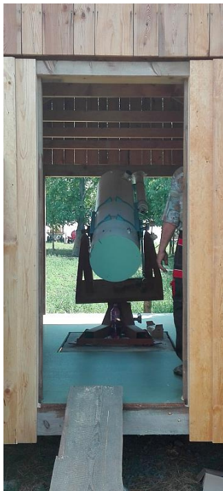
Dalekohled je na vidlicové montáži.
