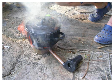
Předvádění důmyslného vaříče na dřevo, poháněného ventilátorem na baterii. Funguje jako kovářská výheň.
