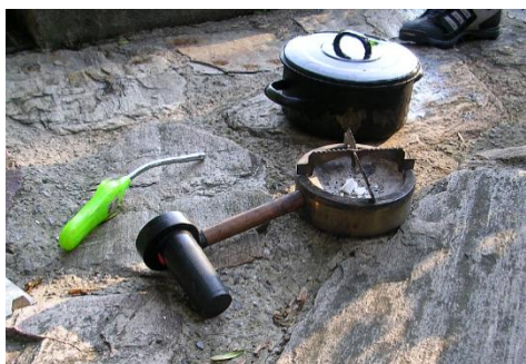
Předvádění důmyslného vaříče na dřevo, poháněného ventilátorem na baterii. Funguje jako kovářská výheň.
