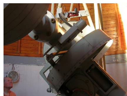
Jemné pohyby v deklinaci a rektascenzi, jak je vyřešila brněnská firma Astrolab.
