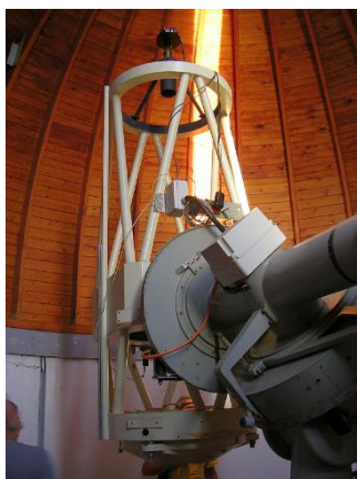
60 cm reflektor z Carl-Zeiss Jena určený pro stelární astronomii. Dříve osazen fotoelektrickým fotometrem v cassegrainové ohnisku, dnes má namontovanou CCD kamerou v primárním ohnisku.
