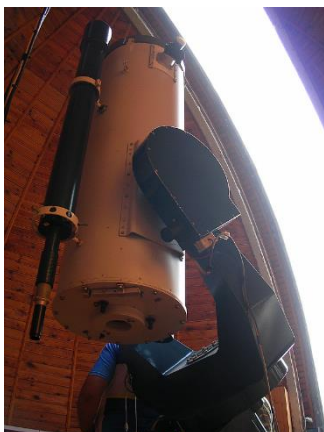
Hurbanovská čtyřcítka je hlavním dalekohledem pro veřejná noční pozorování na zdejší hvězdárně. Spřažený refraktor lze využít rovněž na projekci Slunce.
