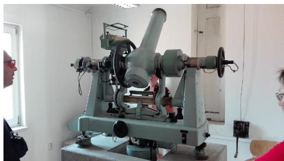
Tento pasážník od firmy Carl Zeiss Jena má tak přesné libely, že je podle mne prakticky neurovnatelný.
