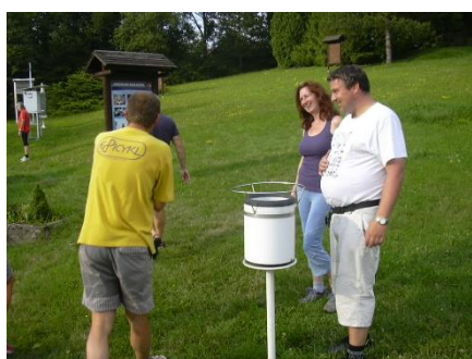
Automatizovaný ombrometr vybavený serdálem, zejména pro menší druhy ptactva.
