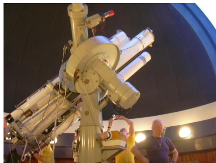
Hlavní sluneční baterie teleskopů.
